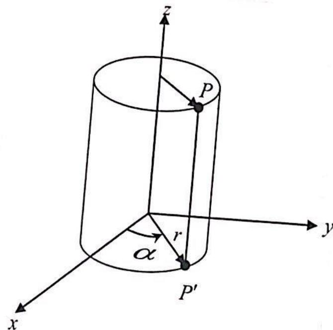
2)  $\alpha$ =sabit olan  $P(r,\alpha,z)$  noktaları  $x$  ekseni ile  $\alpha$  açısı yapın ve  $z$  ekseninden geçen bir düzlem (yani düzlemler) üzerinde bulunanlar.
