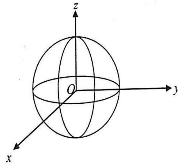
2)  $\alpha$ =sabit olan  $P(r,\alpha,\beta)$  noktalari z ekseniinden geçen ve  $xoz$  düzleme ile sabit  $\alpha$  açısı yapın düzlemin üzerinde bulunurlar.
